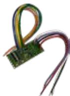
**Concentratore miniaturizzato a 2 ingressi cablati con connessioni pigtail**
